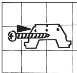
Fissare il supporto di sostegno alla parete utilizzando le viti e le apposite rondelle in dotazione.
