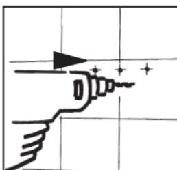
Faça furos com um mínimo de 80 mm de profundidade com ajuda de uma broca para pedra de 8 mm.
