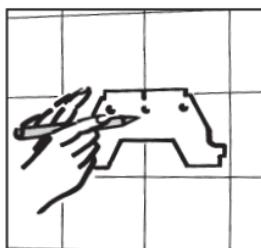
Posizionare orizzontalmente sulla parete il supporto di fissaggio all'altezza prescelta. Segnare i 3 fori di fissaggio utilizzando il supporto come sagoma. Assicurarsi che al di sotto di punti nei quali vengono praticati i fori non siano presenti tubature d'acqua o conduttori elettrici.
