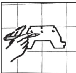
Sitúe la placa de montaje horizontalmente respecto a la pared y a la altura deseada. Marque la posición de los 3 agujeros de sujeción, utilizando la placa de montaje como plantilla para taladrar. Asegúrese que no pase ninguna cañería de agua o conducto de corriente por detrás de los agujeros marcados.
