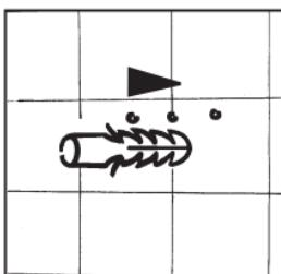
Schlagen Sie die beiliegenden Dübel in die Bohrungen ein.
