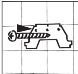
Befestigen Sie die Montageplatte mit den beiliegenden Schrauben und U-Scheiben an der Wand.
