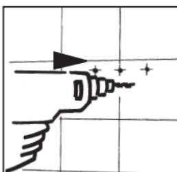
Percez aux endroits marqués à la perceuse à métal de Ø 8 mm, minimum 80 mm de profondeur.
