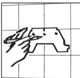
Positionnez le socle de montage à la hauteur souhaitée horizontalement au mur. Marquez la position des 3 perçages pour fixations en utilisant le socle de montage comme gabarit. Assurez vous que l'eau ou le courant ne passent pas sous les marques de ces trous.
