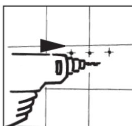
Eseguire i fori con una punta in metallo da 8 mm per una profondità di almeno 80 mm.
