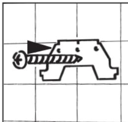
Fixez le socle de montage avec les vis et les rondelles de support (joints) au mur.
