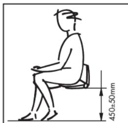
Stabilire innanzitutto l'altezza di seduta. Normalmente essa si colloca a 45 cm (corrispondenti a 55 cm dal lato inferiore del supporto di montaggio) misurati dal pavimento della cabina doccia. Naturalmente si potrà scegliere un'altezza diversa, più bassa o più alta, in relazione alla Vostra statura.
