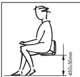
Déterminez la hauteur souhaitée pour votre siège. Normalement, elle est de 45 cm (soit 55 cm pour la partie inférieure du socle de montage). Evidemment, vous pouvez aussi fixer le siège plus haut ou plus bas en fonction de votre taille.
