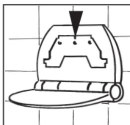
Cuelgue el DUSCHsitz® en la placa de montaje y desplácelo hacia abajo hasta alcanzar la posición correcta.
