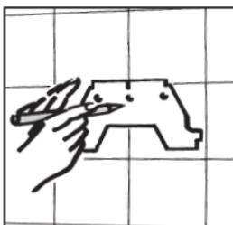
Positionieren Sie die Montageplatte in der gewünschten Höhe waagerecht an der Wand. Markieren Sie die Position der drei Befestigungsbohrungen, indem Sie die Montageplatte als Bohrschablone benutzen. Vergewissern Sie sich, dass unter den markierten Bohrlöchern keine Wasser- oder Stromleitungen verlaufen.
